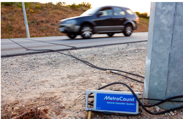
Le RoadPod VT peut classer tout type de véhicule selon des schémas de classe standard ou personnalisés du monde entier.
