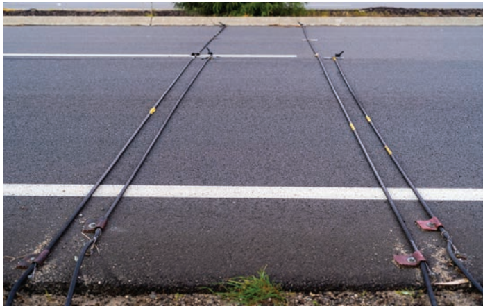
Colectar conjunto de datos únicos por carril de tráfico usando 4 tubos.
