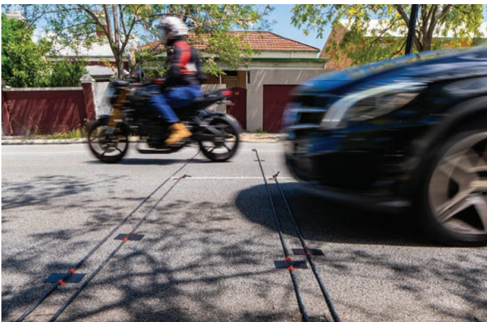
El RoadPod VT4 puede clasificar cualquier tipo de vehículo según el estándar o esquemas de clase personalizados desde todas partes del mundo.
