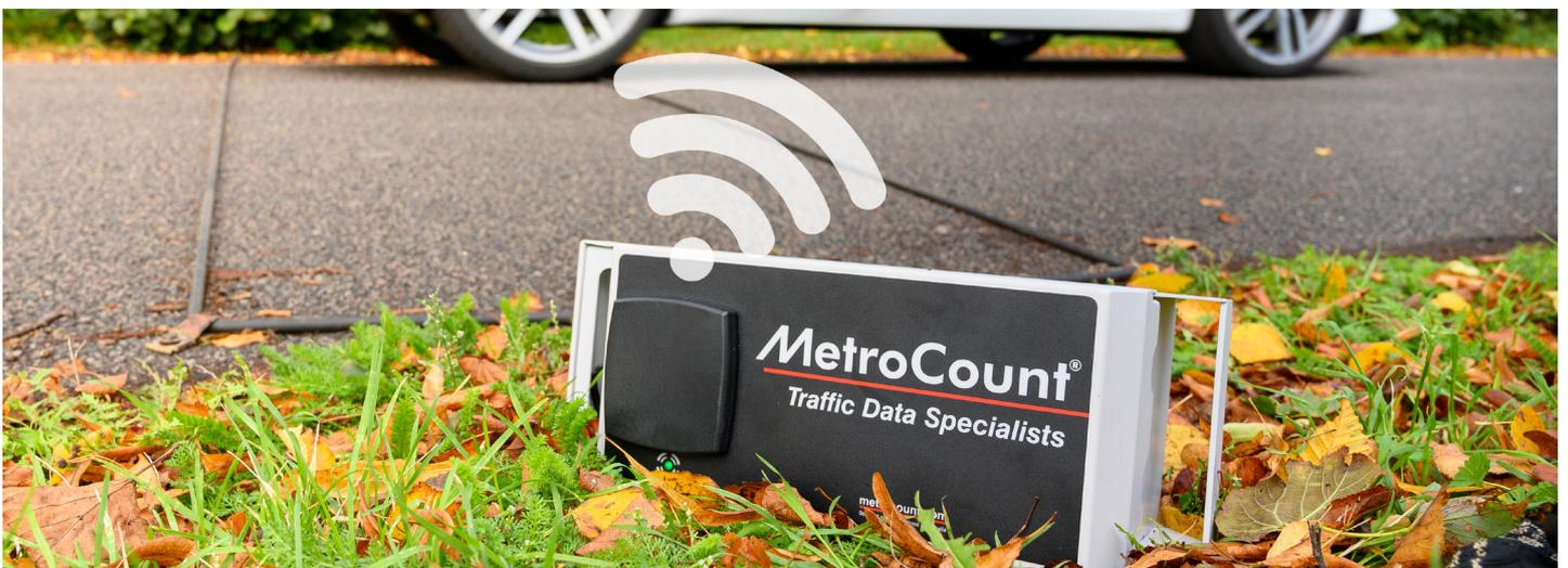
*Diseñado en una caja de acero inoxidable resistente al agua, el Link tiene una duración de batería de hasta 2 años.*
