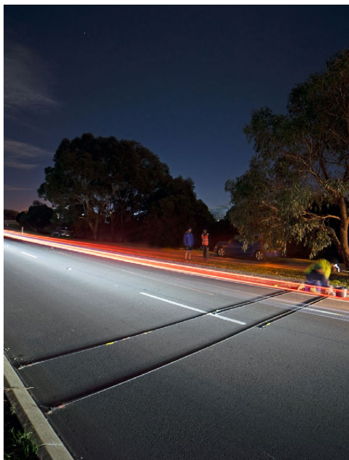
La distinta configurazione RoadPod VT4 a tubo corto / tubo lungo per la raccolta simultanea di dati su due corsie.
